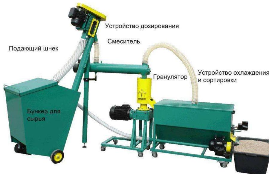
**Назначение:** изготовление топливных или кормовых гранул, кормодобавки – диаметр 3, 5; 4, 5; 6; 8 мм.
